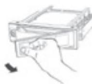
2. Inserire il disco fisso all'interno del rack con l'etichetta del disco (parte stampata) rivolta verso l'alto e assicurarsi che i connettori del disco siano inseriti nel cassetto
