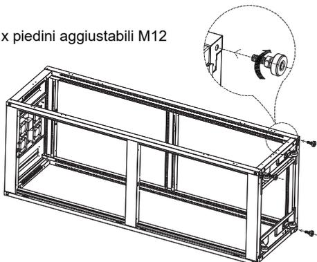
Dopo il montaggio, i piedini M12 devono risultare montati più alti rispetto alle ruote e non devono poggiare sul pavimento.
