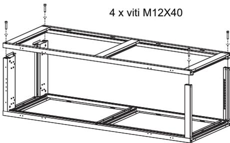
Se durante l'assemblaggio del montante laterale i fori non sono allineati o se risulta uno spazio tra un montante e l'altro di 4mm, si richiede di allentare le viti e rimontare la struttura.
