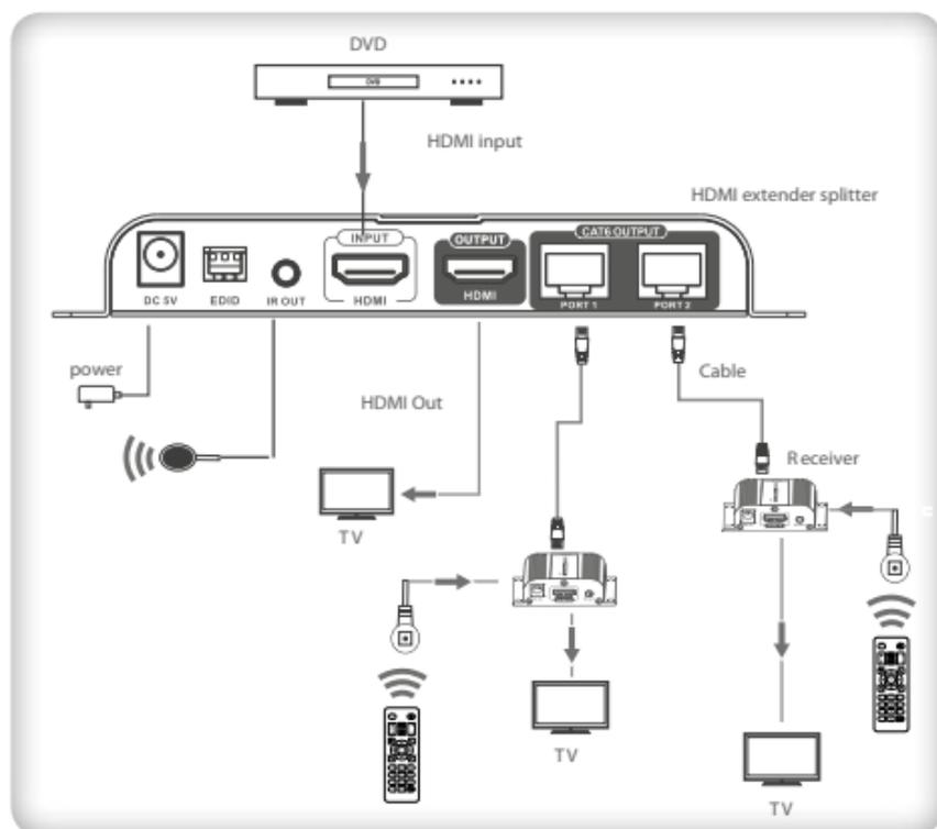
**Osservazione:** non controllare da remoto due ricevitori contemporaneamente perchè questo può provocare delle interferenze.
